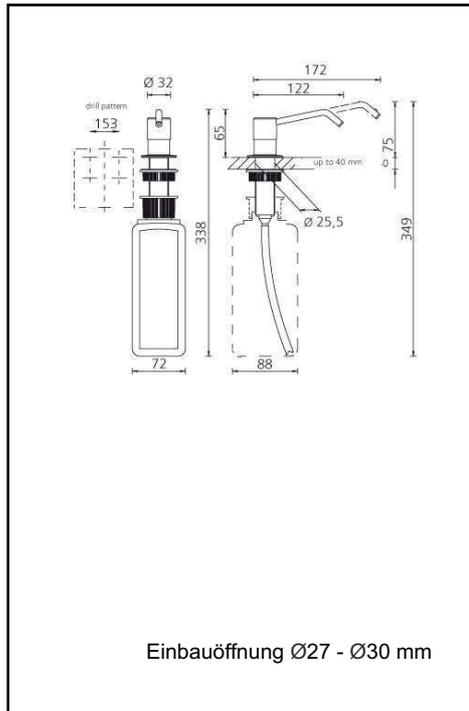
Edelstahl Seifenspender für den Waschtischeinbau zur Dosierung von Flüssigseifen, alkoholischen Desinfektionsmitteln, Spülmitteln, Lotionen etc., Tankinhalt: 1.000 ml
